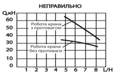
Рисунок 4 - Залежність вантажності крана від вильоту стріли [8]
