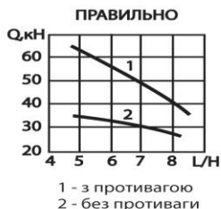
Рисунок 4 - Залежність вантажності крана від вильоту стріли [8]
