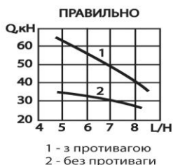
Рисунок 4 - Залежність вантажності крана від вильоту стріли [8]
