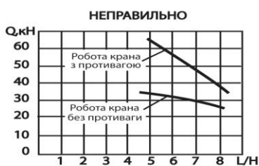
Рисунок 4 - Залежність вантажності крана від вильоту стріли [8]
